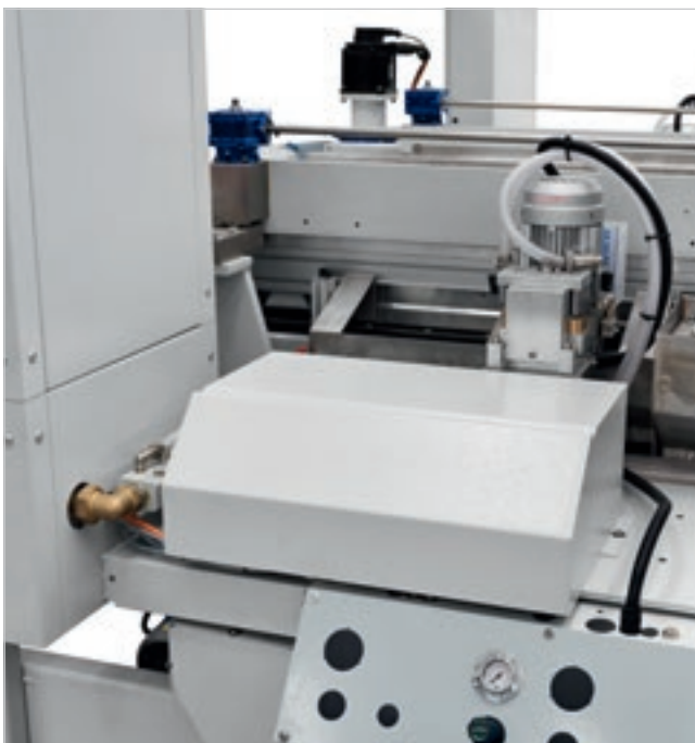
Bearbeitung von bis zu 10 m/min Elektronischer Eckenstoßer zum Ausführen von Abschrägungen und Kanten ab 10 m/min.
